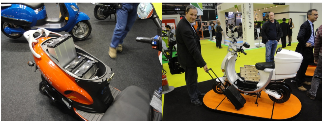
Abbildung 4: Abnehmbare Batterien bei E-Scootern mit Höchstgeschwindigkeit von 45 km/h: E-Tropolis (links) und vmoto (ehemals e-max, rechts)
