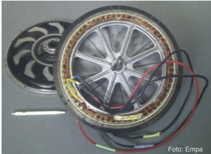
Nabenmotor bis ca. 4kW Leistung, Gewicht 6.5 kg
