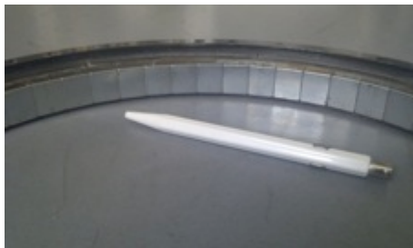
Rotor mit ca. 300g Permanentmagneten
