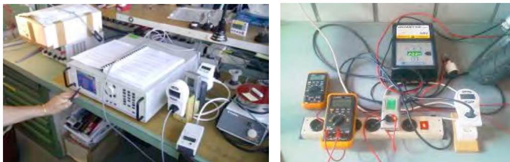
Abbildungen 4: Test verschiedener im Handel erhältlicher Energiekostenmessgeräte.
