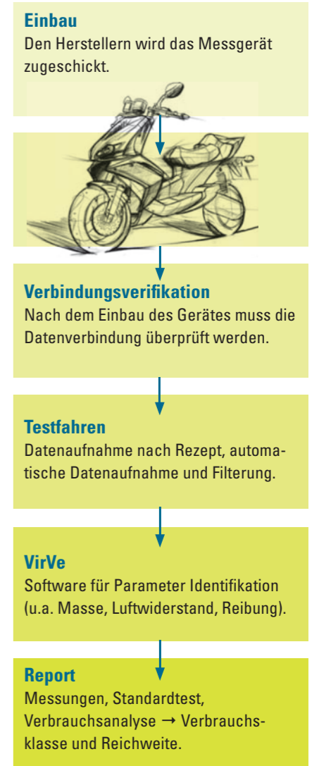
Abbildung 3: Ablauf eines Verbrauchsmessung-Test.
